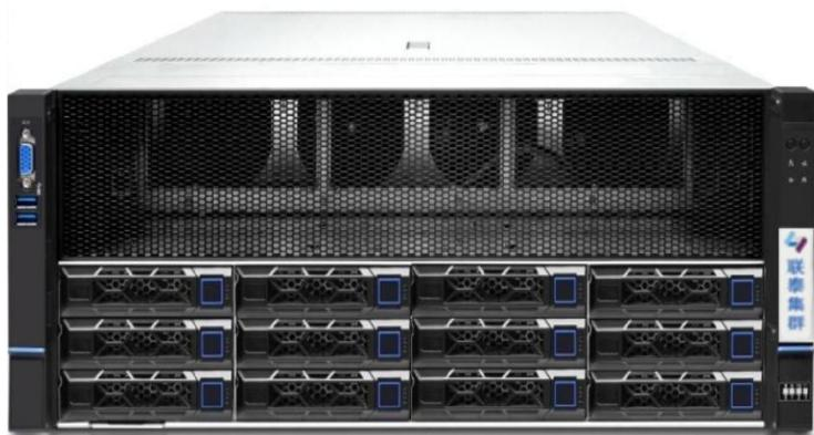
G4238 G3系列是一款基于Intel最新第四/五代至强可扩展处理器的4U双路GPU服务器，支持32个DDR5-5600MHz内存和400G OCP 3.0高速网卡，最大支持13个PCI-E 5.0扩展插槽，提供2倍于PCI-E 4.0的性能和带宽，提供12个3.5英寸热插拔硬盘位，其中4个插槽原生支持PCI-E 5.0协议的U.2接口，相较于普通SSD可提供更高的IO读写能力和更低的延迟，满足高速读写的需求，最大支持10张全高、全长、全宽的GPU加速卡，可用于人工智能、大数据分析、智能医疗等各种并行计算密集型应用，是一款可满足客户全方位需求的全能型GPU服务器产品。
